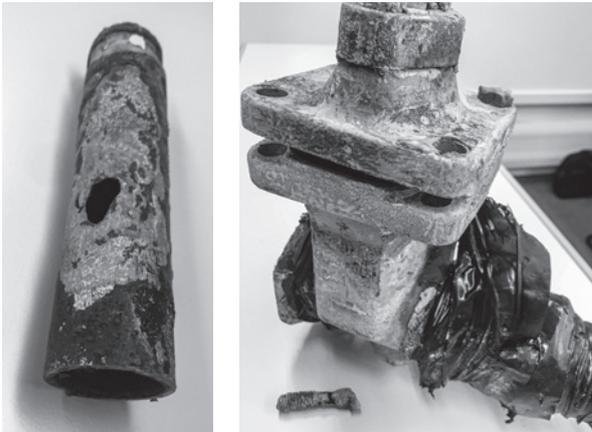
links: 4mm starke Stahl-Rohrleitung mit zwei durchgerosteten Stellen
