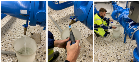
Trinkwasserprobe: Vorbereitung & Spülen / Abflammen / Probenahme
